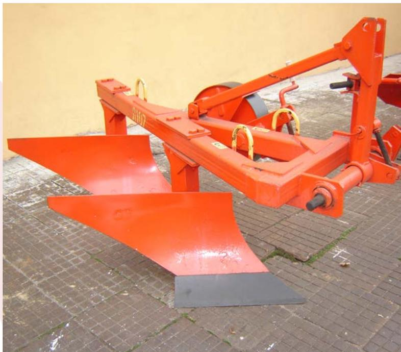
Предназначен для вспашки различных почв с удельным сопротивлением до  $0.9 \text{ кг/см}^3$ , не засоренными камнями во всех климатических зонах. Агрегируется с тракторами тягового класса 0.6; 0.9.
