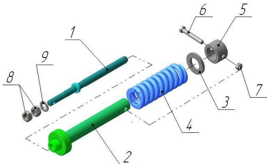
Рисунок 16 – Регулировочный пружинный механизм
