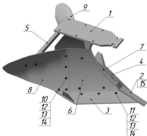
Рисунок 9 – Л-134.02.000 Корпус в сборе
