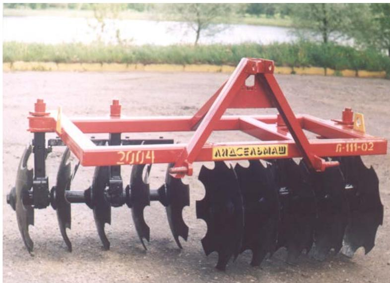
Предназначена для обработки почвы в междурядьях лесных культур и лесных питомниках, ухода за минерализованными и противопожарными полосами, рыхления пластов после вспашки, заделки борозд после вспашки вразвал.
